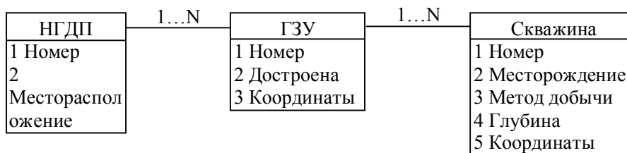
Рисунок 3 – Схема связей сущностей проекта
