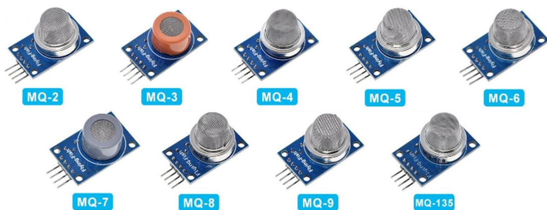
Рисунок 1 – Датчики газа серии MQ: MQ-2 – пропан C_3H_8 , метан CH_4 , н-бутан C_4H_{10} ; MQ-3 – пары C_2H_5OH ; MQ-4 – природный газ; MQ-5 – метан CH_4 , пропан C_3H_8 ; MQ-6 – сжиженный нефтяной газ; MQ-7 – угарный газ CO ; MQ-8 – H_2 ; MQ-9 – угарный газ CO , метан CH_4 ; MQ-135 – аммиак NH_3 , оксиды азота NO_x , углекислый газ CO_2
