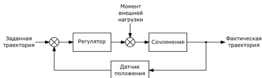
Рисунок 13 – Общая функциональная схема управления сочленениями звеньев манипулятора
