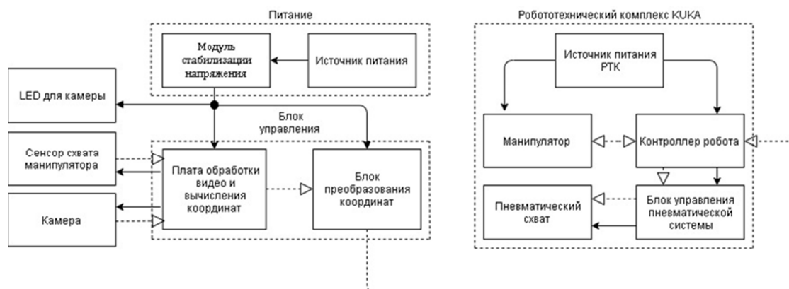
Рисунок 3 – Структурная схема комплекса с СТЗ
