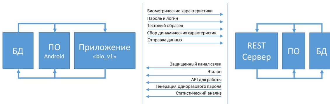
Рисунок 2 – Архитектура системы аутентификации и идентификации пользователей
