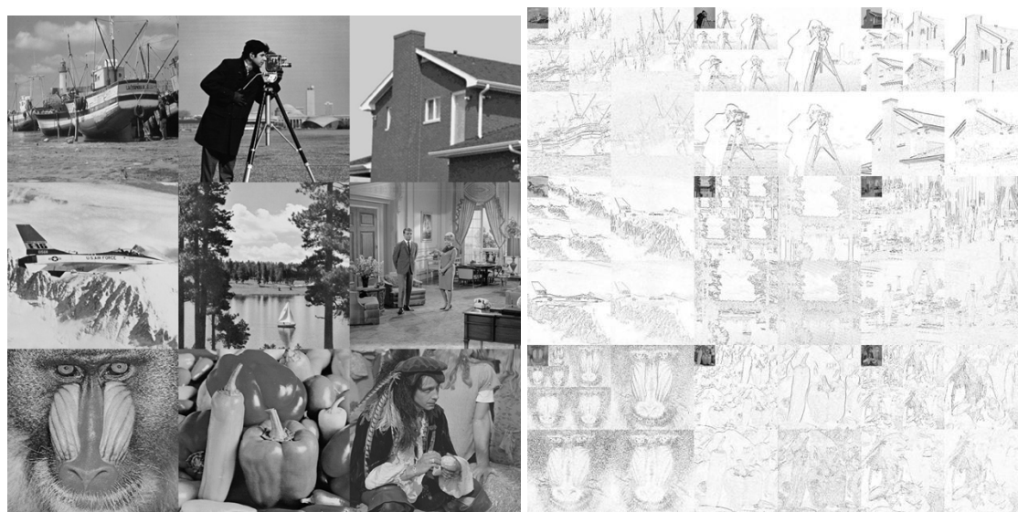
Рисунок 1 – К преобразованию изображений. Слева – исходные тестовые изображения. Справа – кратно-масштабное ортогональное вейвлет-преобразование Хаара исходных изображений
