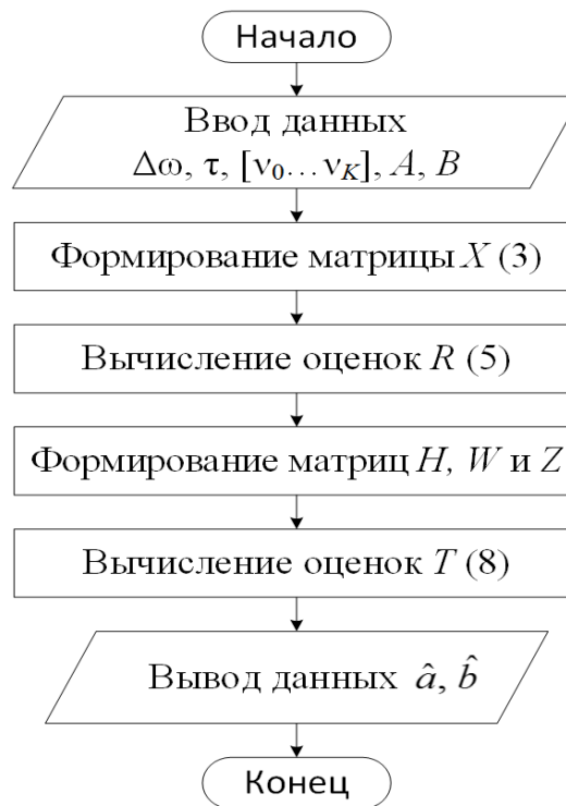
Рисунок 2 – Структурная схема алгоритма вычисления оценок комплексных амплитуд a и b
