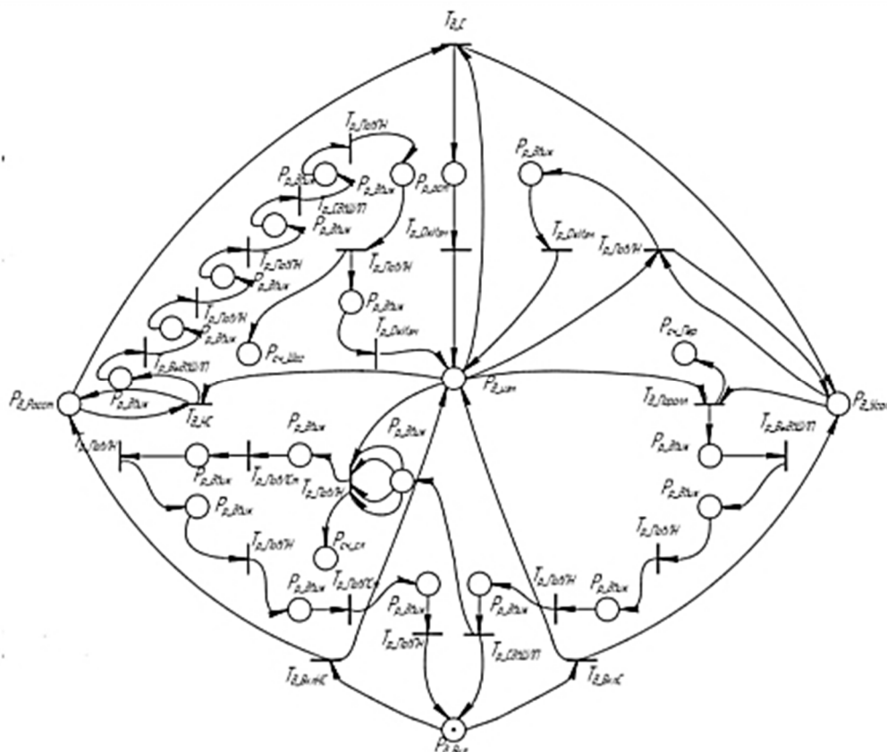
Рисунок 9 – Алгоритм обхода стен помещения в автоматическом режиме
