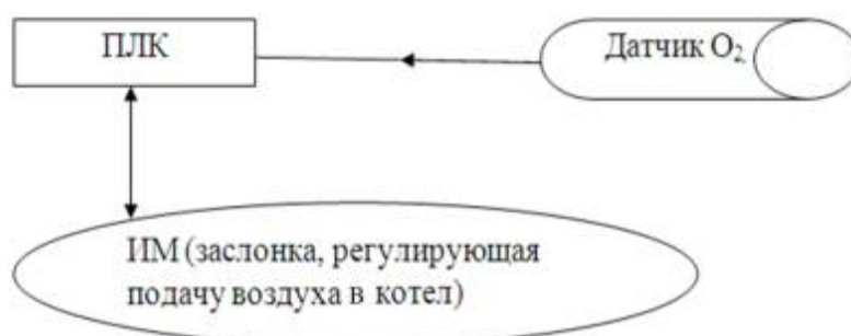
Рисунок 4 – Структурная схема аппаратной части САУ: ПЛК – программируемый логический контроллер; ИМ – исполнительный механизм (электропривод, изменяющий положение воздушной заслонки)
