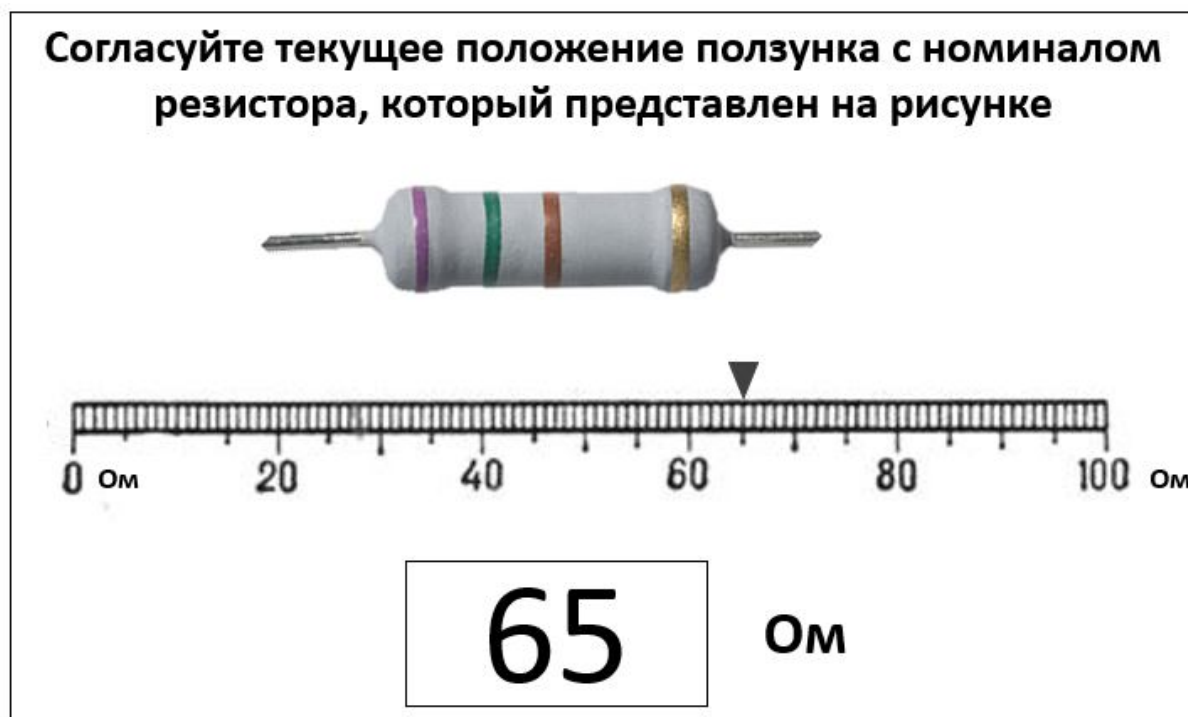
Рисунок 8 – Использование перемещения вдоль шкалы ползунка (в виде черного треугольника) для установки номинала резистора, показанного на рисунке
